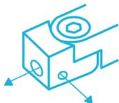
Lösen Sie die Madenschraube und entnehmen Sie die Schraubenaufnahme. Schrauben Sie die Aufnahme und die Schraube zusammen und befestigen Sie danach an der Wand.
